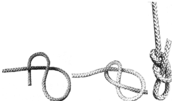
Esecuzione del nodo Savoia (secondo metodo)
